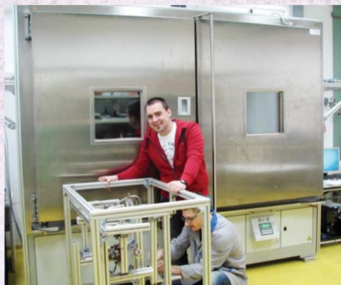
V ozadju klimatska komora, pred njo pa vgradna kletka, kamor Aleš in Erik vgrajujeta bovden potege za testiranje
